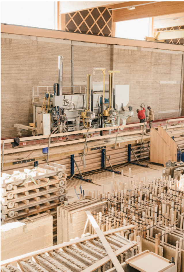
Der Beschicker und der Stampfroboter fahren auf Schienen entlang der Schalung.
