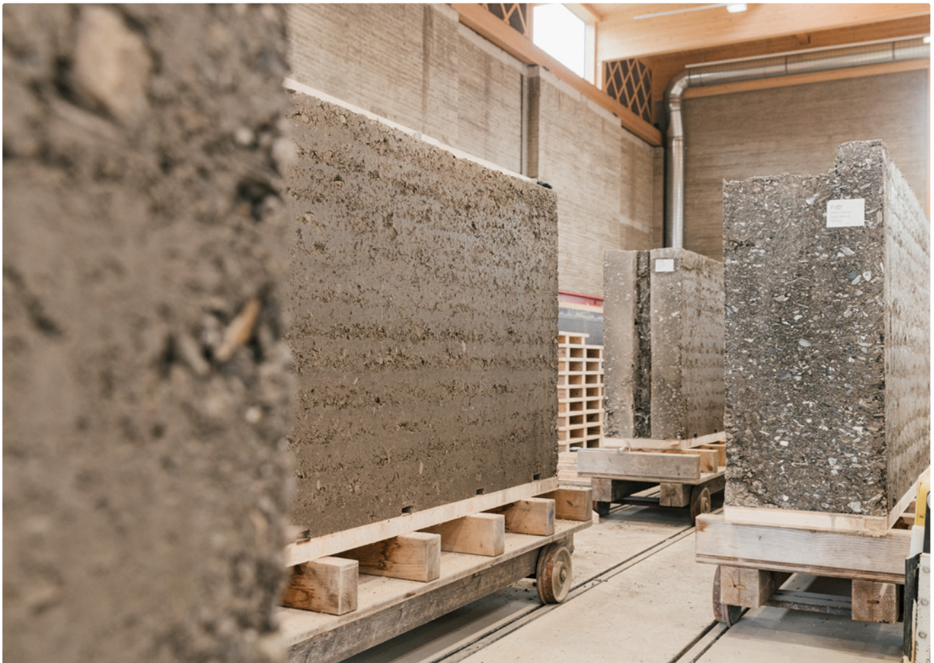
Auf Schienen werden die Stampflehmelemente zu Ihrem Trocknungsort transportiert.
