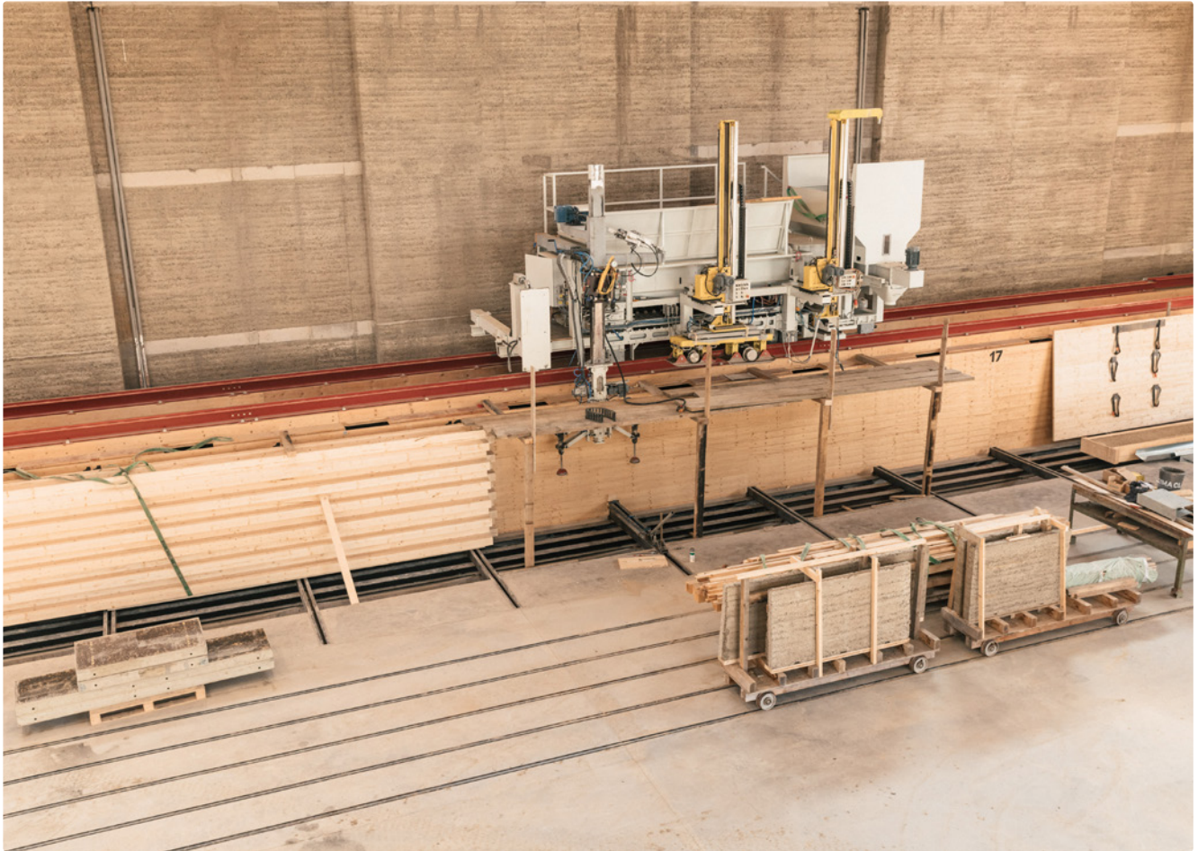
Die Vorderseite der Schalung kann weggenommen und die Fertigteile herausgenommen werden.
